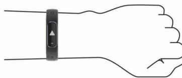
**POZNÁMKA:** Optický snímač je umístěn na zadní straně zařízení.
